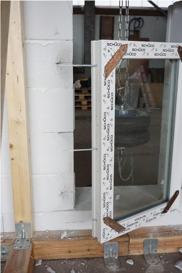
**Bild 17** Versagen nach Abnahme der Fenstersicherung ProtectFIX; Herausreißen der Schrauben aus dem Ytong Ziegel
