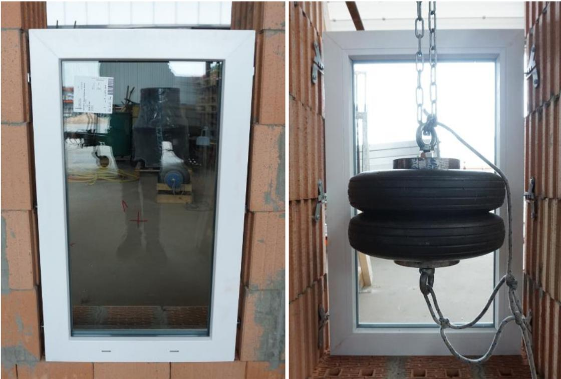
**Bild 11** Element 1: BxH=600 x 1000 [mm], Versuchsaufbau Gesamtansicht, Anprallstelle 1
