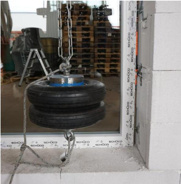
**Bild 18** Element 4: Anprallstelle (nah der Fenstersicherungsglasche)
